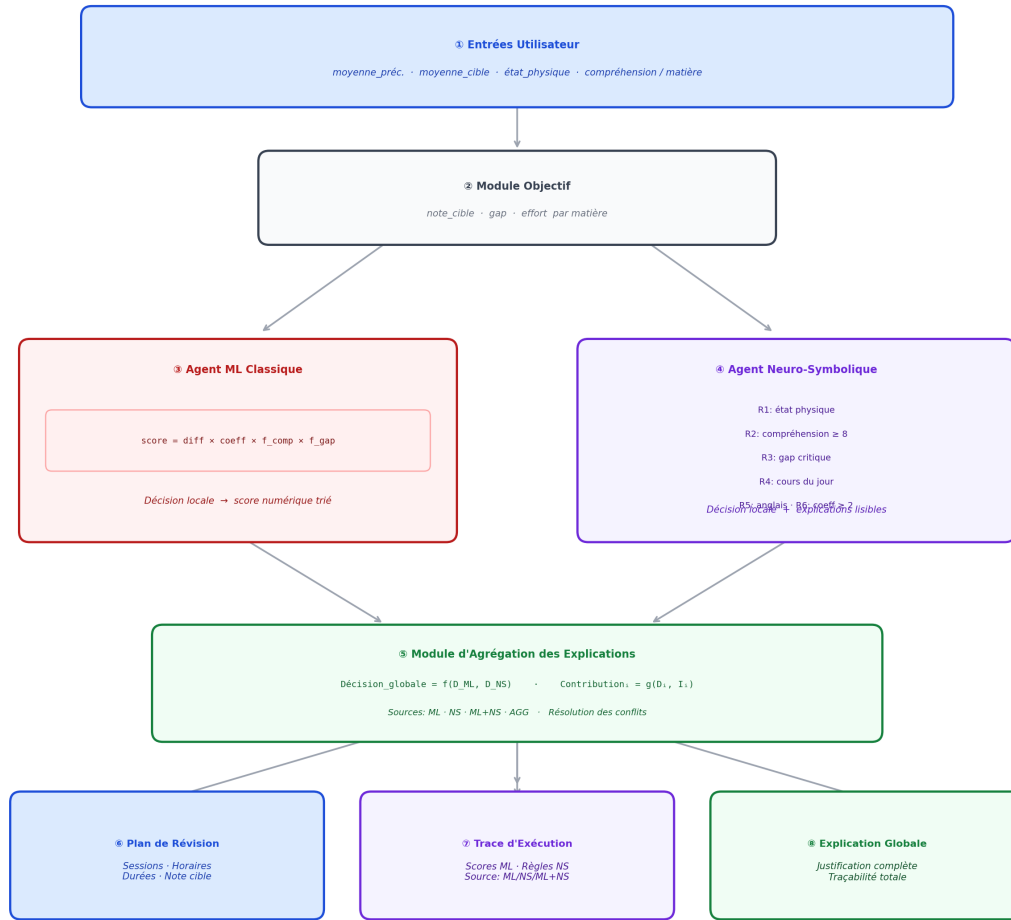
FIGURE 6.1 – Architecture du prototype SMAH : pipeline décisionnel du Study Planner
