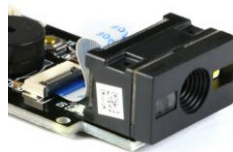
FIGURE 3.3. Modèle du scanner GM65
