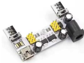
FIGURE 3.4. Alimentation modèle MB102
